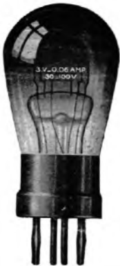
Philips-Miniwatt A-310 Gloeispanning 3 Volt Gloeistroom 0,06 Amp. Anodespanning 40-100 V.
